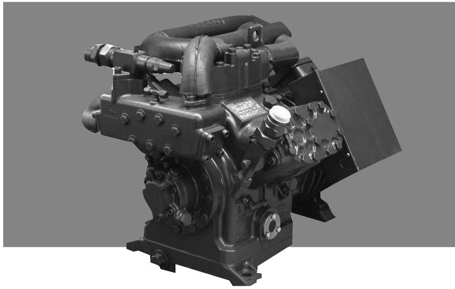
■ I compressori a due stadi sono già disponibili nella gamma dei compressori a 6 cilindri con potenza nominale da 15 a 35 HP. La Dorin sta ora collaudando i compressori a 4 cilindri della gamma con potenza nominale da 5 a 15 HP.
